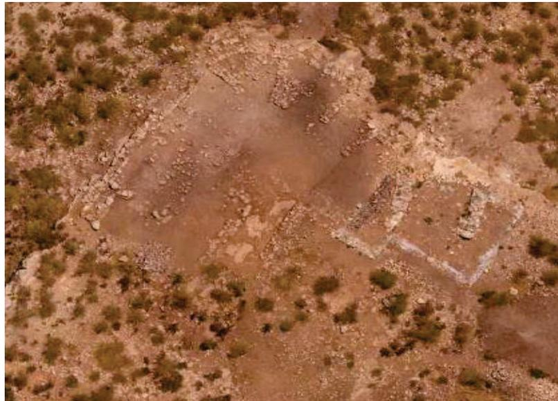
Figura 13. Ortofoto rectificada donde se observa la doble curva que traza la muralla tanto para salvar la esquina noreste como para generar el muro norte del pasillo de la puerta oriental.
